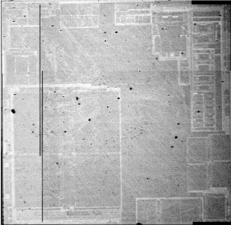
Abbildung 3 - Rückseite eines Hardware-Wallet-Mikrokontrollers mittels einer Infrarotkamera (Bild-Stitch von verschiedenen Teilbildern)
